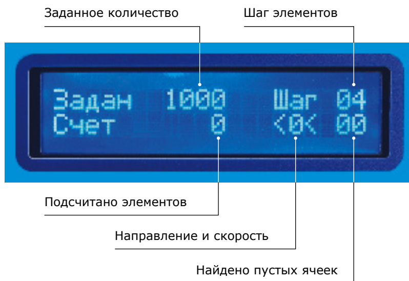
Рис. 3 Описание основного дисплея. Стрелками показано направление счета. Между стрелками-скорость вращения приемной катушки.
